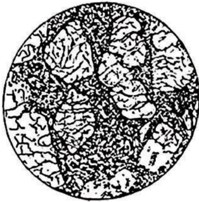
სურ.93. მეიმეჩიტის პორფირული სტრუქტურა; ჩანანინსკლებში სერპენტიზებული ოლივინი, ძირითად მასაში:პიროქსენები, მადნეული მინერალები და მინა (ზავარიცკის მიხედვით, 1955)
