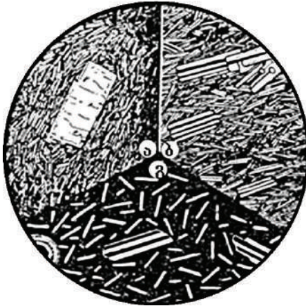
სურ.62. პორფირული სტრუქტურა: ა - ტრაქიტი; ბ, გ - ანდეზიტი; ძირითადი მასის სტრუქტურა: ა - ტრაქიტული, ბ - პილოტაქსიტური, გ - ჰილოპილიტური http://mineral.nsu.ru/educat/article/16/index.html
